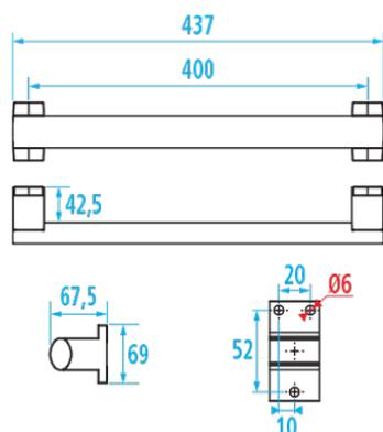
Tube elliptique en aluminium blanc 38 x 25 mm. Cache-fixations en résine de synthèse blancs.
