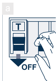
Couper l'alimentation électrique générale
