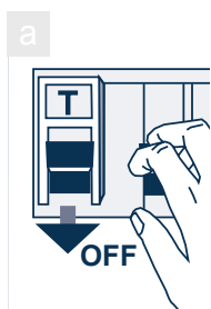
Couper l'alimentation électrique générale
