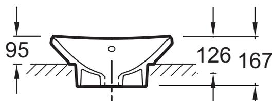
Descriptif CCTP : Vasque à poser 41 cm. E1325. Collection : ESCALE. Dimensions : 41 x 41 cm. Poids : 8,9 kg. Matériau : Céramique. Type d'installation : Posé. ROBINETTERIE CONSEILLÉE : Le mitigeur élégant et racé Margaux et son levier joystick ou le mitigeur Purist au design audacieux.
