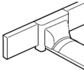
Permet la dérivation d'une moulure 60x20/75x20 mm vers un passage de plancher réf. 032800.
