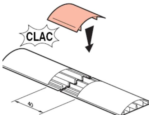
Montage avec passage de plancher 92x20mm
