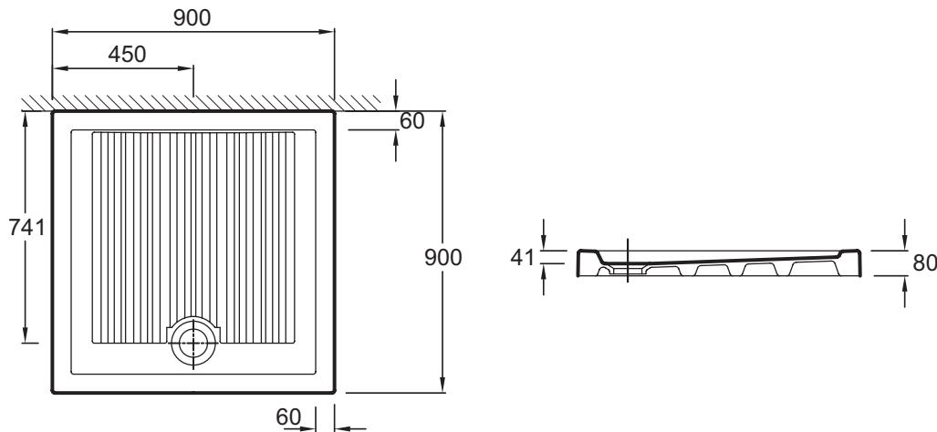
Description : Receveur à poser carré 90 x 90 cm, bonde à l'avant. EN104. Collection : KYREO. Dimensions : 90 x 90 cm. Poids : 39,8 kg. Matériau : Céramique. Type d'installation : Posé. Forme : Carré. Diamètre de bonde : 90. FACILITE DE POSE: Plage sur le pourtour du receveur permettant l'adaptation de toute cabine de douche. IMPLANTATION : Possible de pieds. Garantie 10 ans.
