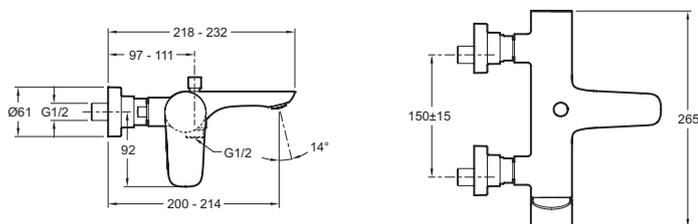
Description : Mitigeur bain-douche mural.. E72282. Collection : ALEO. Poids : 2,3 kg. Type d'installation : Mural. Normes et réglementations : ACS (Attestation Conformité Sanitaire) : 10 ACC LY 113. Raccords : Avec raccords et rosaces murales. Mécanisme : Cartouche à disques céramique. Entraxe : 150 ± 15 mm.
