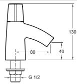
Description : Robinet indépendant de lave-mains (eau froide). E12817-7. Collection : ELEVATION. Type d'installation : 1 trou. Normes et réglementations : ACS : 15 ACC LY 081. Débit : 8 l/mn sous 3 bars. Mécanisme : Tête à disques céramique. Brise-jet anti-calcaire intégré.
