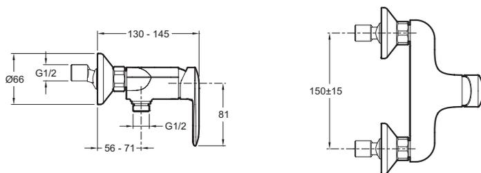
Description : Mitigeur douche mural. E99463. Collection : KUMIN. Poids : 1,3 kg. Type d'installation : Mural. Normes et réglementations : ACS (Attestation Conformité Sanitaire) : 10 ACC LY 113 / NF ECAU : E1 C2 A3 U3 (Ge3). Débit : 13 l/mn. Raccords : Avec raccords muraux. Mécanisme : Cartouche à disques céramique avec limiteur de débit sensitif. Entraxe : 150 +/- 15 mm.
