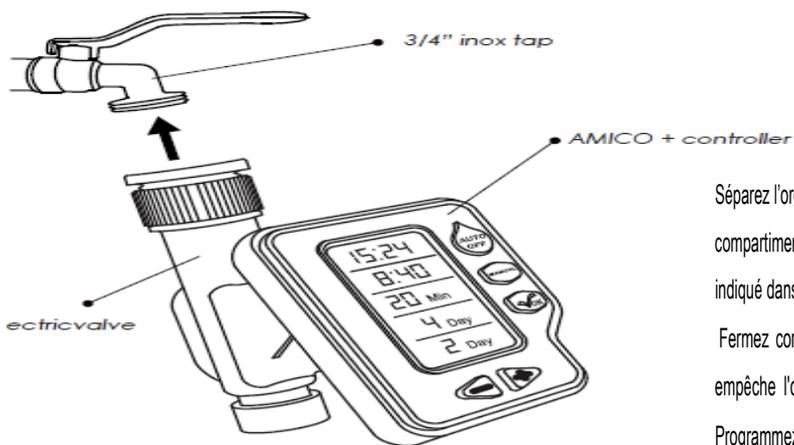
Séparez l'organe électronique de la valve électrique au moment d'installer les piles. Ouvrez le compartiment de la batterie et insérez 2 Piles 1,5 volts AA. Assurez-vous de suivre la polarité comme indiqué dans le compartiment.
